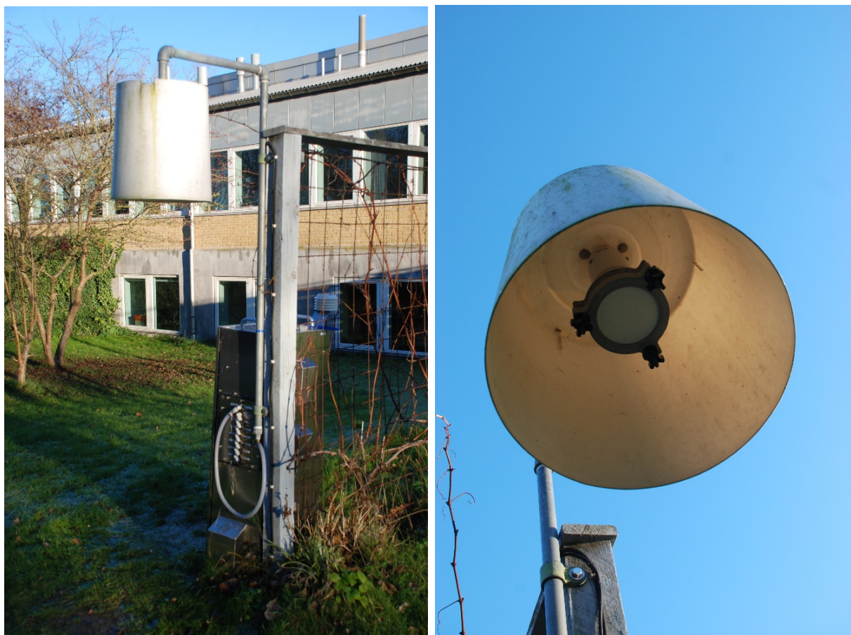
Figur 6.6. Udstyr til opsamling af pesticider i luft på Risø (Roskilde). Til venstre ses en filteropsamler, som anvendes til at suge med konstant luftflow gennem opsamlingsmaterialet. Samlet volumen er omkring 58 m 3 for en døgnopsamling. Opsamlingsmaterialet er placeret inde i den hvide afskærmning, som beskytter mod nedbør. Til højre ses holder til opsamlingsmaterialet (filter og PUF/XAD), der både opsamler pesticider på partikel- og gasfase. Efterfølgende ekstraheres hele prøven med ASE (Accelerated Solvent Extraction) og prøveekstraktet analyseres med gaskromatografi – dobbelt massepektrometri (GC-MS-MS).
