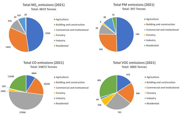
Figur S.6 NOx-, PM-, CO- og VOC-emissioner fordelt på sektorer for non-road maskiner i 2021.
