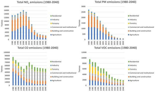
Figur S.11 NO<sub>x</sub>-, PM-, CO- og VOC-emissioner pr. delsektor for non-road maskiner fra 1980-2040.
